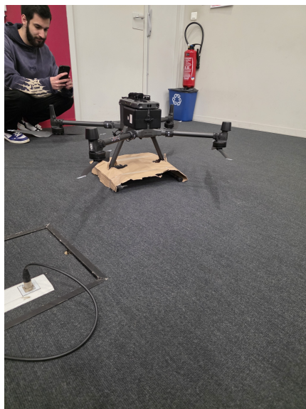
FIGURE 4.13 – Capteurs bloqués par un morceau de carton
